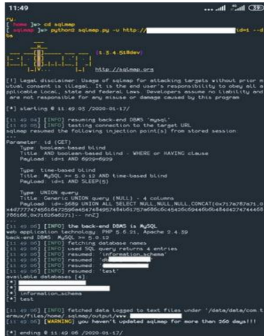
Gambar 11. SQLMap Mengeksekusi Perintah SQL Injection
